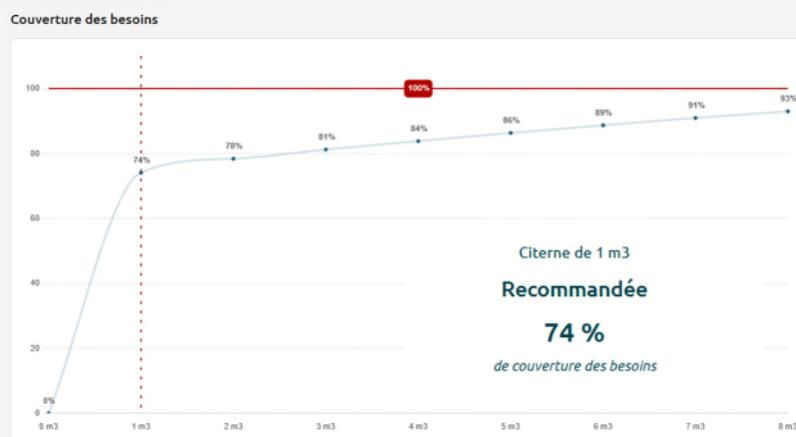
Figure 22 - Estimation du volume de la cuve de récupération des eaux pluviales
